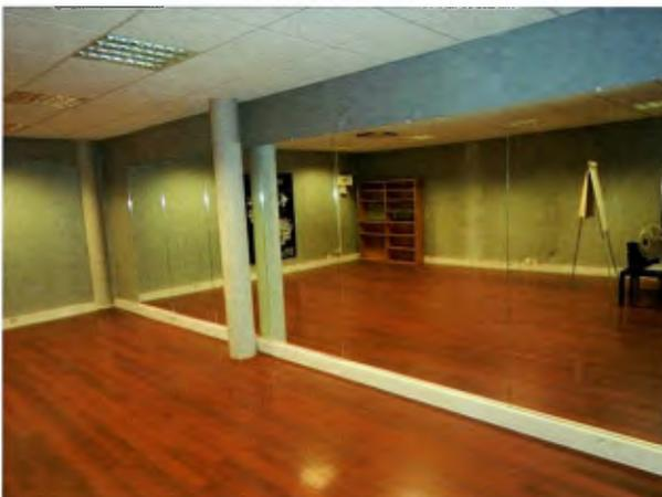
Le plafond est un faux-plafond, dans lequel sont encastrés des pavés lumineux assurant l'éclairage ainsi qu'une cassette de chauffage.
